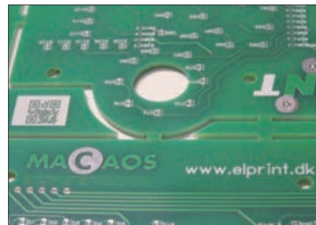
Samarbejdet med de kinesiske producenter har ført til udviklingen af et lasergraverings-system, som for rundt regnet 100.000 kroner kan implementeres in-line i en produktionslinje. På den måde får man en pæn unik identifikationskode af hvert enkelt print til enten processtyring eller kvalitetssikring.
